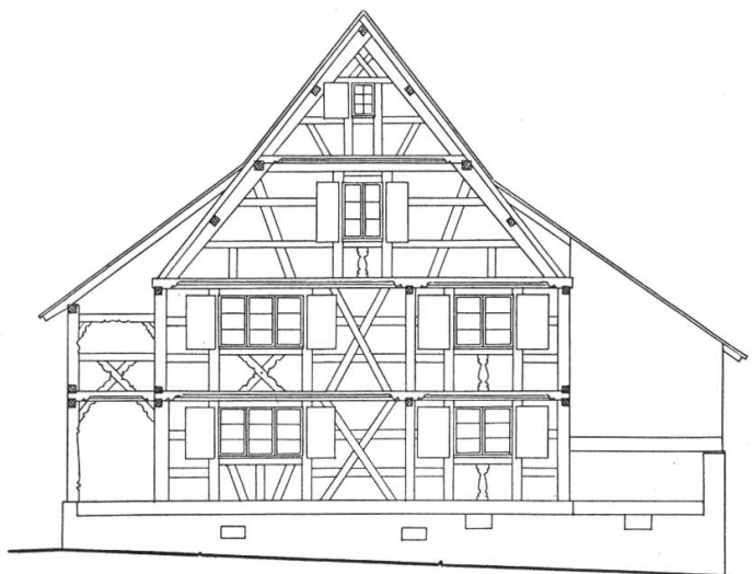
Abb. 18 Giebelwand mit nordwest- schweizerischem Fachwerk, Allschwil, 1746 (Kt. Baselland)
