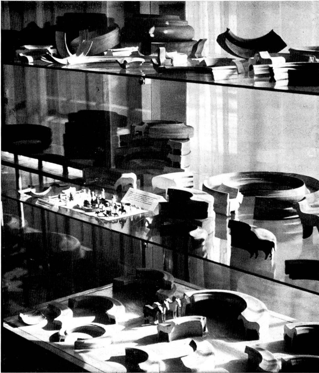
Erzgebirgisches Spielzeugmuseum Seiffen. Vom gedrehten Reifen zum fertigen Tier. Die endgültige Tierform wird erst nach der Spaltung des Reifens sichtbar. Aus einem Reifen lassen sich 60 Tiere abspalten. In einem zweiten Arbeitsgang erhalten sie mit Schnitzmesser und Pinsel den letzten Schliff. Photo Thomas Christen
