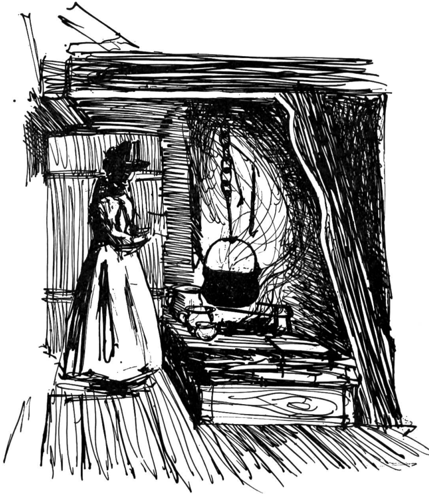
Fig. 7. Feu ouvert, sur dalle surélevée, surmonté d'une cheminée en maçonnerie. – Lötschental (Valais).
