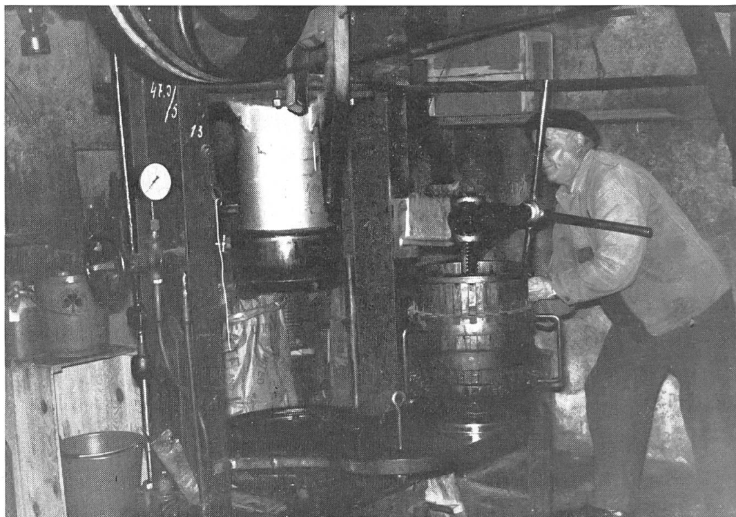
Fig. 5. La corbeille est sur la table percée et l'huilier, à l'aide du cric, fait tomber par terre les plaques et les deux paquets de tourteaux.
