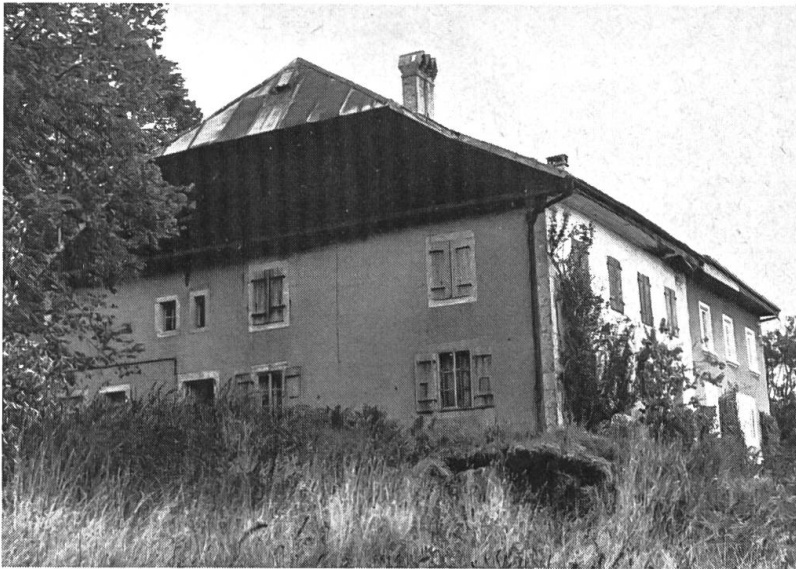
Fig. 9 Les Rasses (c. de Bullet). Exemple de ferme à pignons latéraux. La façade principale regarde toujours au Sud-Est, mais se trouve sous le mur gouttereau. La ligne de faîte du toit est parallèle aux courbes de niveaux du terrain.
