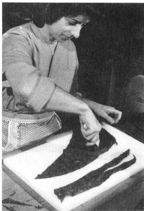
Fig. 3. Taglio della «sottofascia» o della «coperta» con la «rotella».
