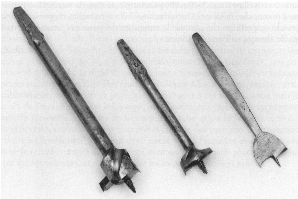
Fig. 9: Deux mèches à centrer, ou à trois pointes, inventées en Angleterre vers 1800. Tout à gauche, issu de la mèche à centrer, un modèle extensible breveté aux USA vers 1850.
