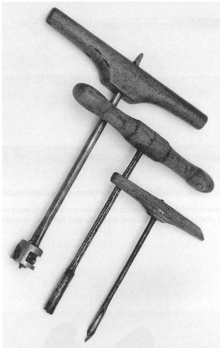
Fig. 2: Trois percets en T. Celui du milieu a une mèche en cuillère à base plate avec languette de pénétration. Celui de droite est le modèle le plus courant, à poche en colimaçon, alors que celui de gauche est un percet à mèche de précision Forstner.
