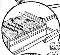
Der ERGA-Doppelauszug ist einwandfreie Präzisionsarbeit. Er läuft auf drei Kugellager- und zwei ortsfesten Rollenpaaren geräuschlos und leicht. Auch die schwer belastete Schublade läßt sich durch einen Fingerdruck bewegen.
