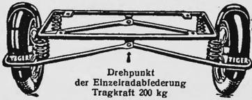
Drehpunkt der Einzelradabfederung Tragkraft 200 kg
