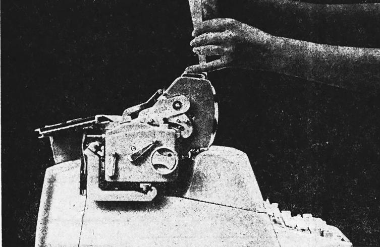
Der Handkantenkontakt wird beim Einwurf des Kontoblattes in den Formulartrichter ohne zusätzliche Bewegung, wie von selbst, betätigt. Er bedingt somit keine Manipulation, bietet aber folgende wichtigen Vorteile.
