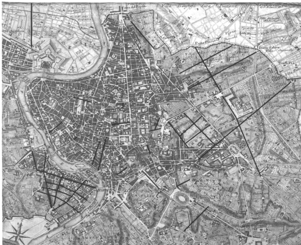
Fig. 5: Proposte per l'apertura di nuove strade o per la rettificazione di tracciati viari esistenti secondo il piano "Varia Consilia pro bono urbis Romae", restituzione grafica sulla pianta di G.B. Nolli 1748
