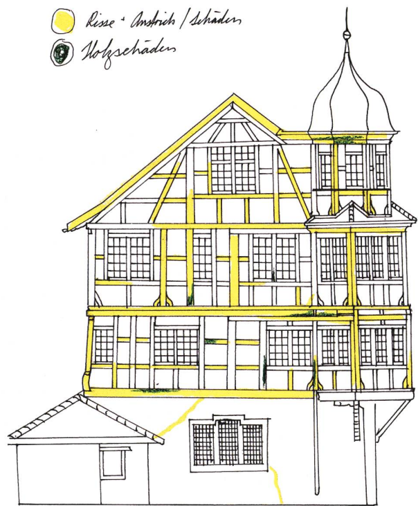
Eine Bestandesaufnahme durch Absolventen des Ausbildungslehrgangs Handwerk in der Denkmalpflege zeigt, dass nur wenige Holzteile dringend erneuert werden muss (grün) und auf dem Riegelwerk der Farbanstrich dringend erneuert werden muss (gelb). Zudem sind im Verputz des Erdgeschosses verschiedene, jedoch nicht besorgniserregende Risse zu erkennen. Foto: Tommy Raths/Denkmalpflege Stadt St. Gallen.
