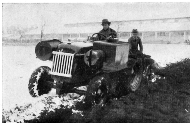
Bühler-Traktor mit Holzkohlengas-Antrieb
