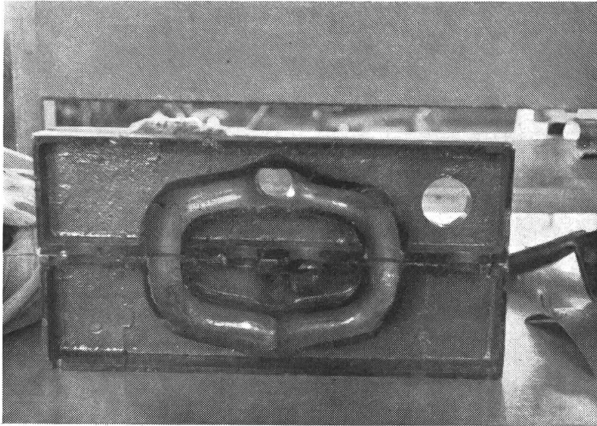
Fig. 65: Vorwärmeeinrichtung aufgeschnitten. Der Ansaugkanal wird allseitig von den Auspuffgasen umströmt.
