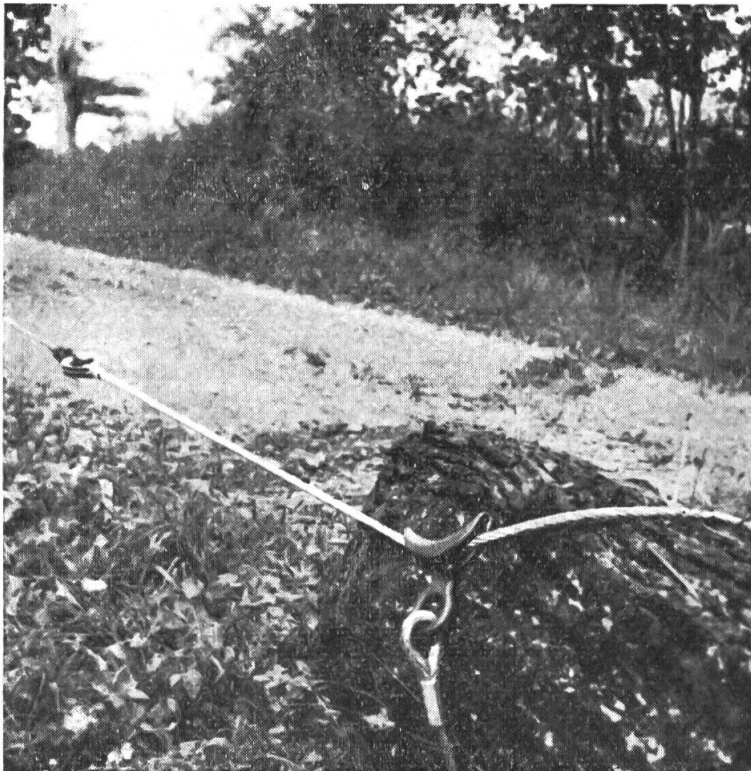
Drahtseilschlinge zum Rücken von Stämmen.
