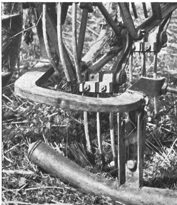
Abb. 1: Ein Schleifschuh ersetzt die Grabschar
