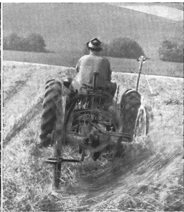
Abb. 2: Der Kartoffelgraber bei der Zettarbeit
