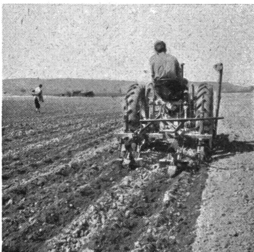
Abb. 1a: Zweireihiger Pflanzlochapparat, angebaut an den Vielzwecktraktor.
