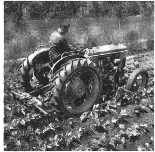
Links: Hackarbeit mit rückwärtigem Gerät, durch Hilfsperson gesteuert. Rechts: Hackarbeit mit unterhalb des Traktors befestigtem Gerät.
