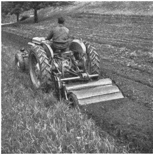
Links: Fräsen mit Rotavator, Arbeitsbreite 135 cm, Arbeitstiefe bis zu 20 cm. Rechts: Vevey 560 beim Antrieb einer Messerfräse; Arbeitsbreite 180 cm, Arbeitstiefe bis 30 cm und mehr.
