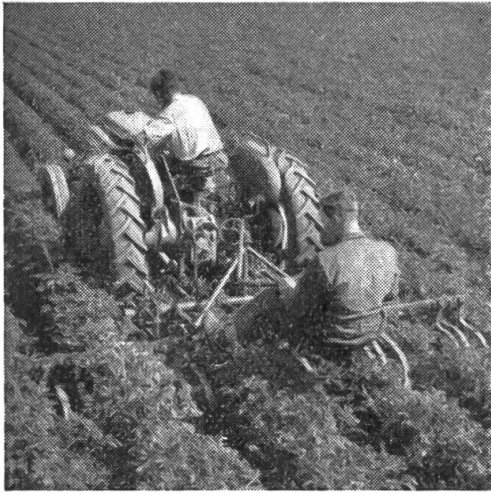
Links: Hackarbeit mit rückwärtigem Gerät, durch Hilfsperson gesteuert. Rechts: Hackarbeit mit unterhalb des Traktors befestigtem Gerät.
