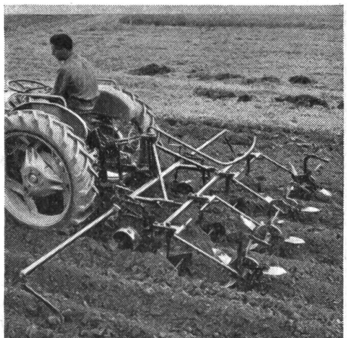
Links: Anbringen eines Geräteträgers unter dem Traktor. Der Montage-Wagen wird durch zwei Bolzen am Träger befestigt. Das Befestigen der ganzen Vorrichtung mit den Trägern und der Hydraulik wird von einer Person in ungefähr 4 Minuten ausgeführt. Rechts: Hackarbeit mit rückwärtigem Gerät, seitlich starr montiert.
