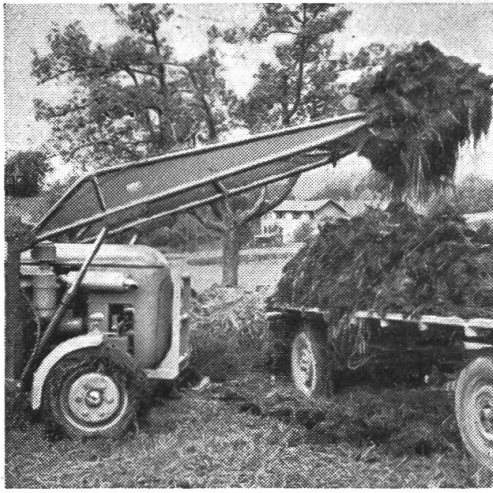
Links: Aufladen von Stallmist mit Frontlader. Rechts: Aufladen von Heu mit Frontlader.
