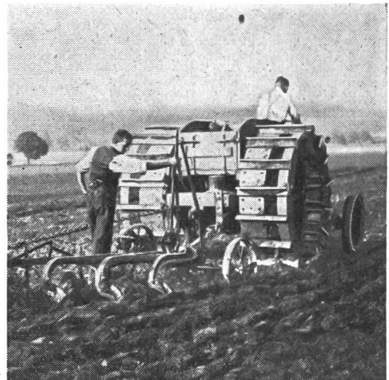
34 a und 34 b Um ein Einsinken zu verhindern, wurden Radverbreiterungen angebracht.
