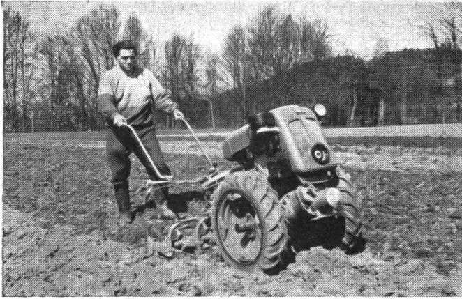
Links: Einachstraktor S-Super mit rotierender, 140 cm breiter Hackegge. Rechts: Mähen mit dem neuen Einachstraktor Rapid S-Spezial, 12 PS, mit 190 cm Mähbalken.
