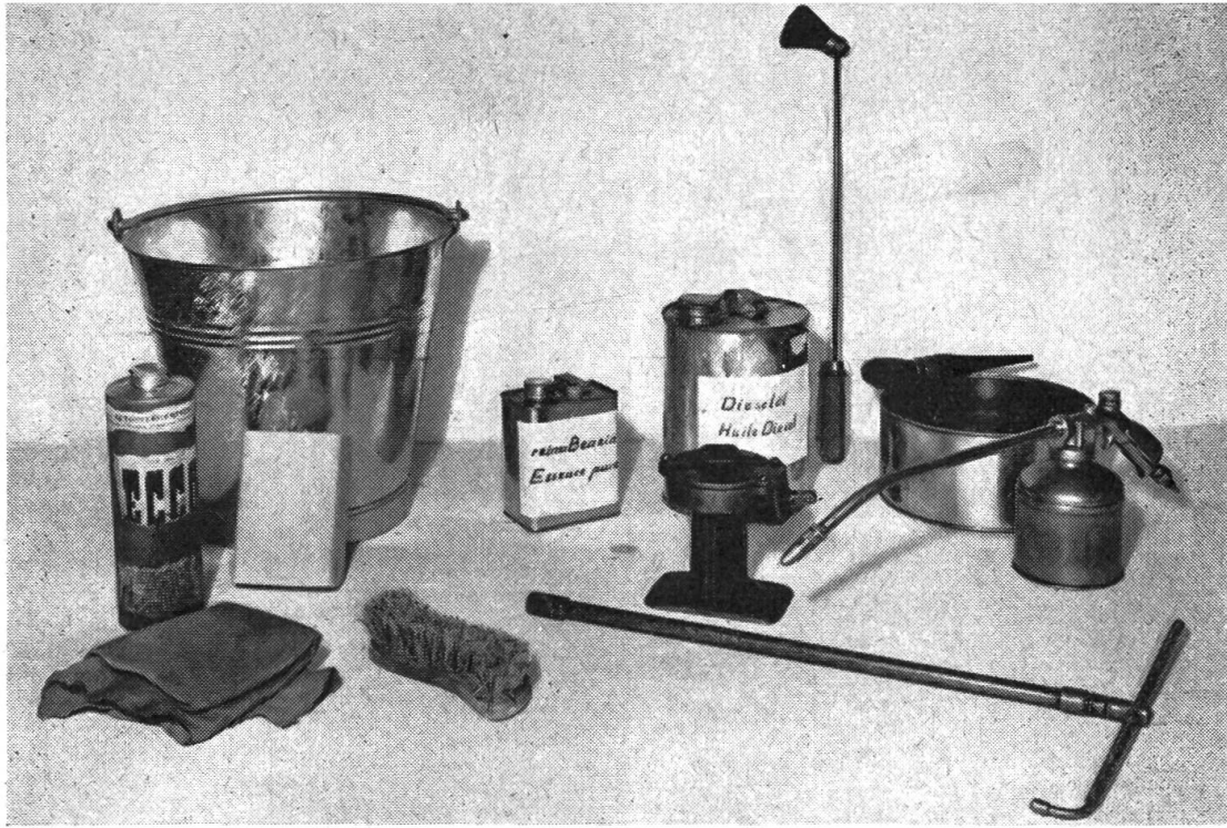
Abb. 2: Reinigungssatz: Kanne Dieselöl Wagenheber Kanne mit Reinbenzin und mit Schaummittel Zerstäuber, wenn Pressluft 2 Twist. Kessel mit Schwamm und Hirschleder Pinsel, Rundbürste 2 kleine Büchsen
