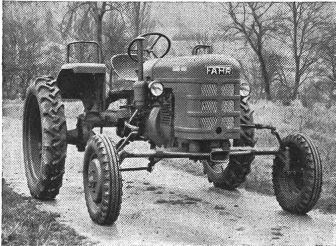
Abb. 3: Fahr-Dieseltraktor D 130 H auf grösste Spurweite von 1924 mm eingestellt.
