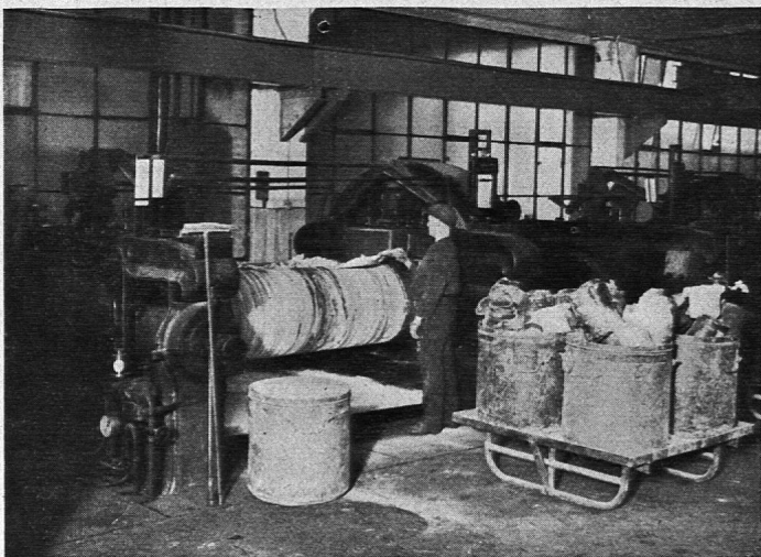
Mischwalzwerk. Kneten des Kautschuks und Einmischen der Füllstoffe.
