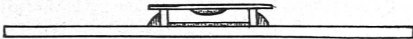
Fig. 1. Feuchte Kammer mit hängendem Tropfen. Glasring mit Wachs befestigt. Am Grunde etwas Wasser.
