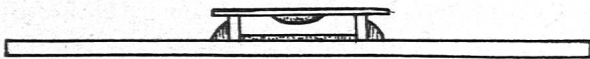
Fig. 1. Feuchte Kammer mit hängendem Tropfen. Glasring mit Wachs befestigt. Am Grunde etwas Wasser.
