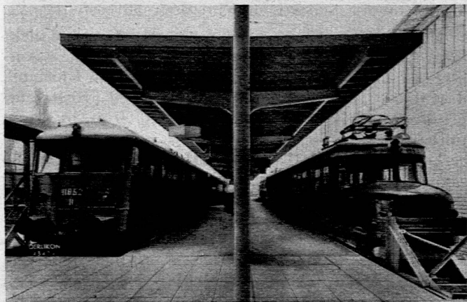
Der LA-Bahnhof. Links die 12 000-PS-Lokomotive — die stärkste Lokomotive der Welt — rechts der Doppelschnelltriebwagen, beide für die Schweizerischen Bundesbahnen geliefert.
