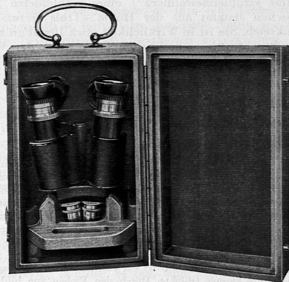
Die Binokularlupe im Versorgungskasten. Unten das einschiebbare Holzstativ, welches behelfsmässig ein richtiges Stativ ersetzen kann.
