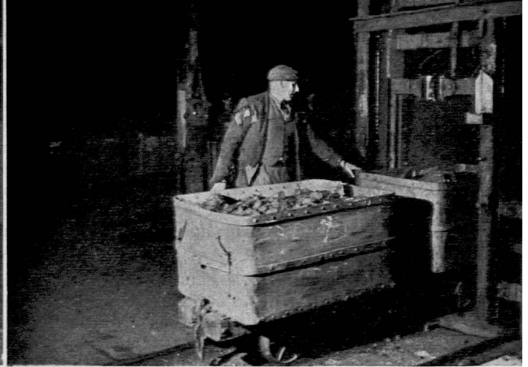
Hier werden zwei volle Rollwagen in den Lift geschoben. Den Wagen ist mit Kreide angeschrieben, aus welchem Stoll oder von welcher Arbeitsgruppe sie kommen. Die Bergleute werden nach dem «Output», nach dem was sie fördern, entlohnt.
