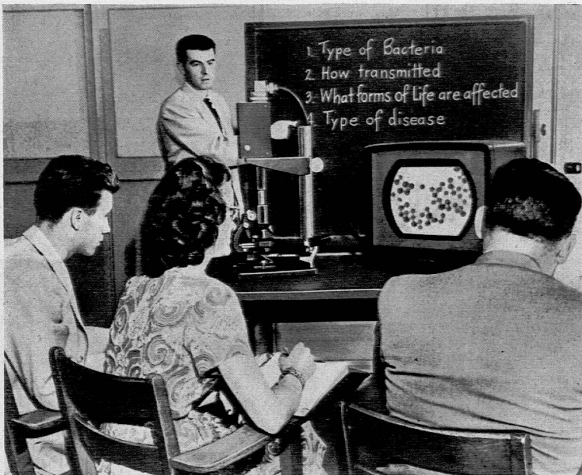
Das Fernsehen hat Anlass zur Schaffung neuartiger Unterrichtsbehelfe gegeben, wie des Fernmikroskopes, das in zahlreichen nordamerikanischen Lehranstalten und Universitäten eingeführt ist. Eine kleine Fernsehkamera wird über das Okular des Lichtmikroskops geschoben. Auf dem benachbarten Empfänger erscheint das belle Bild des Präparates in hoher Vergrößerung.
