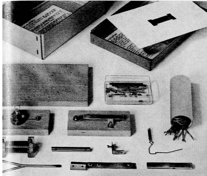
Bausatz B (reihenweise von links oben nach rechts unten): Experimentierbrett, Kleinmaterialschatel mit Zutaten, Lämpchenhalter, Taster/Schalter, Kabel, Spule, Kern, Kontaktwinkel, Zeiger, Schraubenzieher, Summerzusatz, Telegraphenzusatz.
