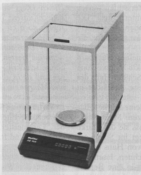
Mettler AE166 Elektronische Analysenwaage mit DeltaRange. Wägebereich: 0...60/162 g. Ablesbarkeit: 0,1/1 mg. Electronic analytical balance with DeltaRange. Weighing range: 0...60/162 g. Readability: 0,1/1 mg.
