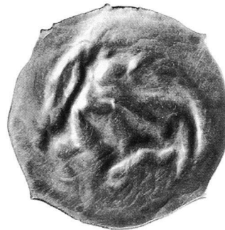
Abb. 8d. Durch die massive Dehnung wird der Schrötling wellenförmig deformiert. Oben und unten die gezähnten Kanten. Mst. 2:1.
