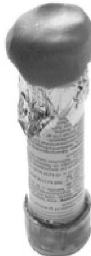
Abb. 11: Die Aluminiumform wird mit Plastilin fixiert.
