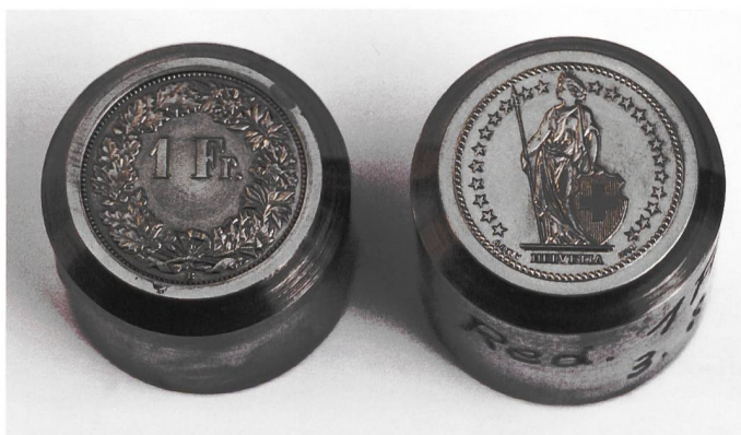
Abb. 25: Einfranken-Stempel: Original Wertseite und Reduktion Bildseite, Stempelarchiv Swissmint.
