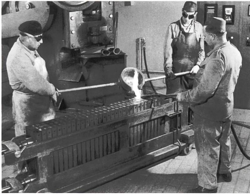
Abb. 21: Giessen von Silberbarren als Vorbereitung für die Zainenherstellung 52 .
