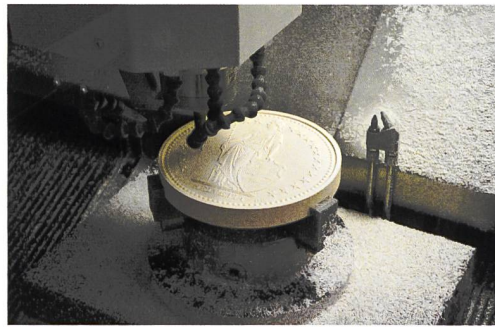
Abb. 36/37: Fräsen des Kunststoffmodells ab den digitalen Daten.
