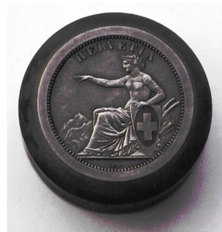
Abb. 10: Originalstempel für den Zweifränkler mit der sitzenden Helvetia von Korn.
