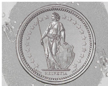
Abb. 34/ 35: Das eingescannte Helvetiamodell links wird vom Swissmint-Graveur Remo Mascherini mit einer speziellen CAD-Software überarbeitet.
