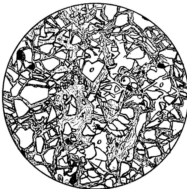
Fig. N° V. — Coupe de la Dunite massive serpentinisée du Koswinsky-Kamen montrant les noyaux d'Olivine dispersés dans la masse d'Antigorite.
