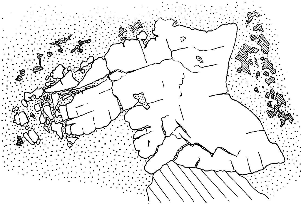
Fig. 7. Anschliffzeichnung: Aufgesprungener Pyrit, von Zinkblende ankorrodiert. Punktiert = Zinkblende; schraffiert rechts oben — links unten = Fahlerz; schraffiert links oben — rechts unten = Kupferkies. Moulins St. Luc. Vergr. 53 ×.
