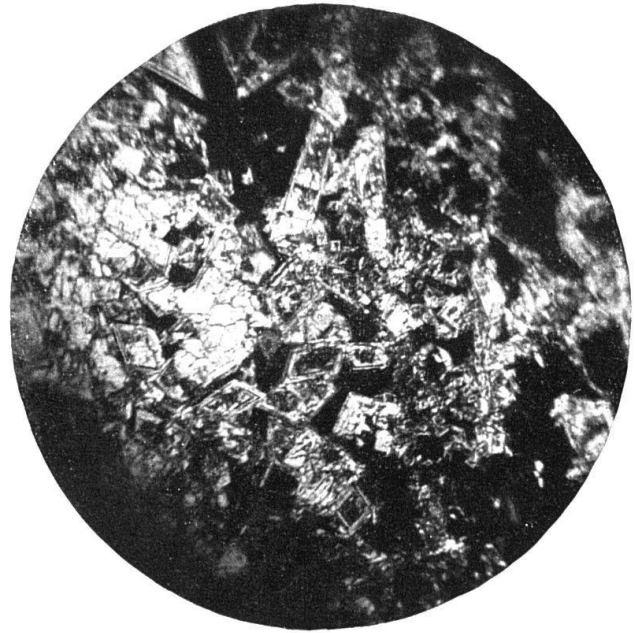
Phot. 17 Rammelsbergit von Fang (St. Luc). Ausgesprochen rhombische Form und zonarer Bau der Individuen Anschliff 200 ×
