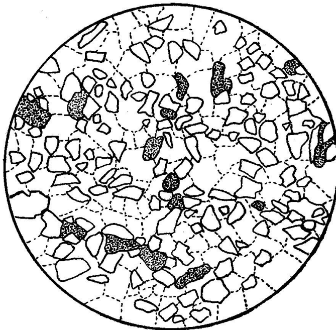
Fig. 16. Kalksandstein (Gruppe IV) mit Basalzement von mesokristallinem Kalzit (weiß mit gestrichelten Korngrenzen) und relativ spärlichen Sandkörnern. Steinbruch Beckenried. Vergr. 40 ×
