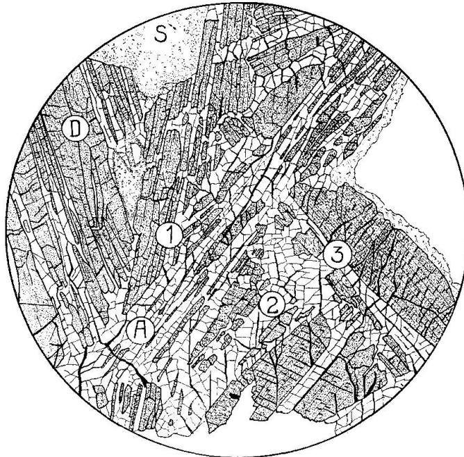
Fig. 6. Dünnschliff einer Verwachsung von Andalusit und Disthen. A = Andalusit, D = Disthen, S = Sericit. Die Lamellensysteme 1, 2 und 3 wurden mit dem Fedorofftisch untersucht (siehe Tabelle auf Seite 336). Vergr. 15 ×.
