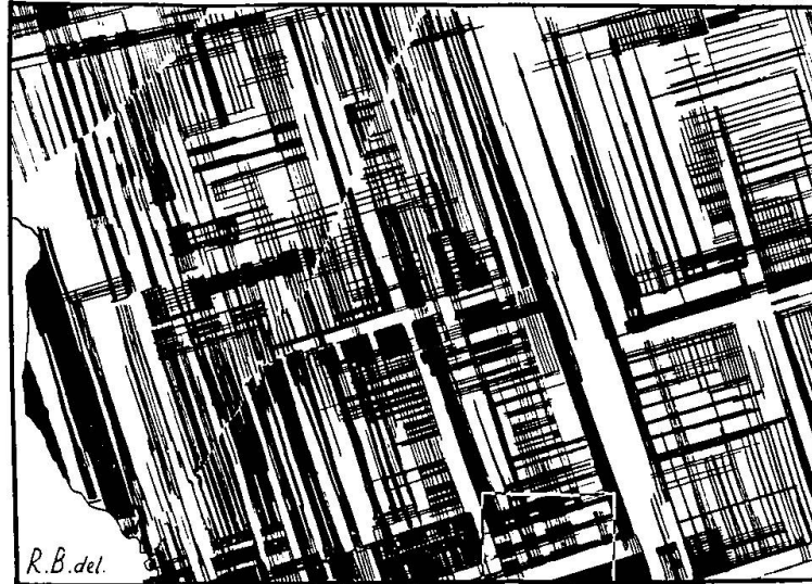
Fig. 1. Mikroclin, Schnitt senkrecht zu beiden Lamellensystemen (ungefähr parallel zur Basis). \times Nicols, Vergr. 53\times . NNW gerichtet Periklinlamellen, Verwachsungsfläche (\bar{1}5.0.2) , senkrecht dazu Albitlamellen, Verwachsungsfläche (010) . Eingerahmtes Rechteck am unteren Bildrand in Fig. 2 und 3 vergrößert dargestellt.
