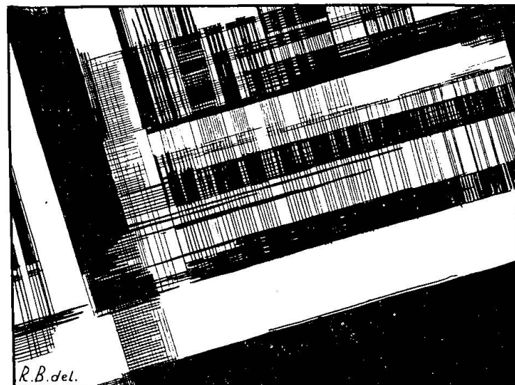
Fig. 2. Eingerahmtes Rechteck von Fig. 1. \times Nicols, Vergr. 365\times . Die groben Lamellen lösen sich z. T. auf in feinste Linien und Gittersysteme.
