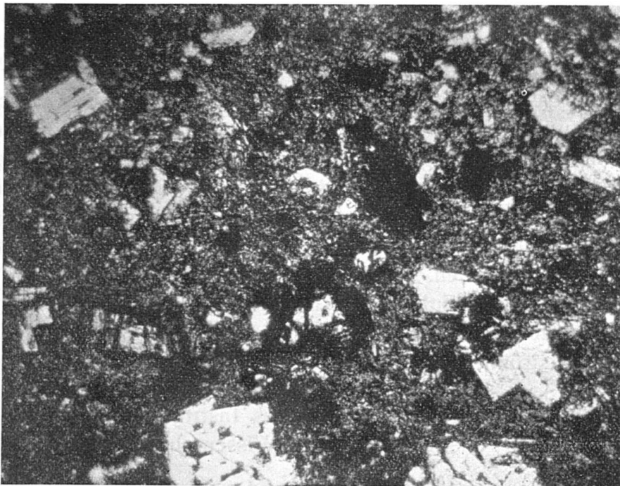
Mikrophotographie 2. Asphaltspuren im Augitandesit vom Sulyomtető. In grösseren Flecken, welche manchmal den Rest des Augitkristalls noch umgeben, fein verteilt in der Grundmasse oder in Spaltrissen, oder Corrosionshöhlen der grösseren Feldspatkristalle
