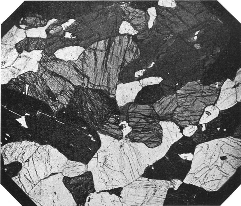
Photos 11 a und b. Mikrophoto des gabbroiden Anzolagesteins. a) Nur mit Polarisator: hell = Plagioklas, hellgrau = Pyroxen, dunkelgrau = Hornblende. // -Textur im Bilde NO — SW verlaufend.
