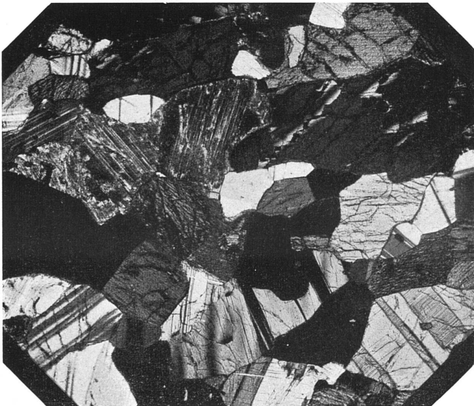
b) Mit \times Nicols: derselbe Schliffausschnitt wie bei a, Plagioklase zeigen einfache Zwillingslamellierung. Vergrößerung 10 \times .
