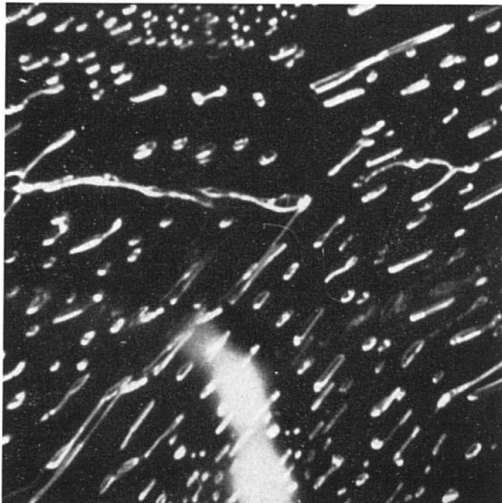
Fig. 3. Typische Fahne, Flüssigkeits- Tröpfchen in Ceylon-Saphir, 250 \times
