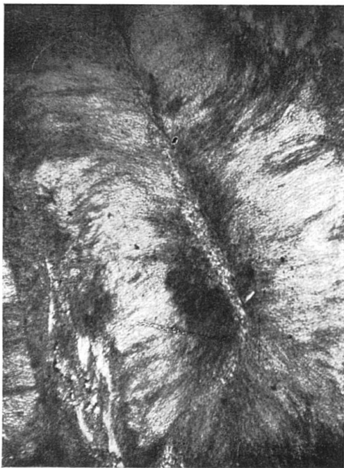
Fig. 4. Cymatolithische Umwandlung eines Spodumenkristalles. Mikroaufnahme parallel c-Achse. Vergr. ca. 20-fach
