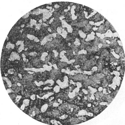
Fig. 9. Anschliff A 2a, senkrecht zur Scherfläche. Scherrichtung = Zeilenrichtung. 8:1
