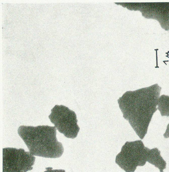
Fig. 4. Quarz leicht mit HF geätzt. Elektronenmikroskopische Aufnahme
