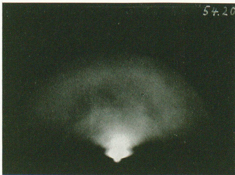
Fig. 2. Quarz mit Quarzpulver poliert. Interferenzen noch schwach sichtbar. Die Ringe stammen vom Poliermittel, das noch an der Oberfläche haftet.
