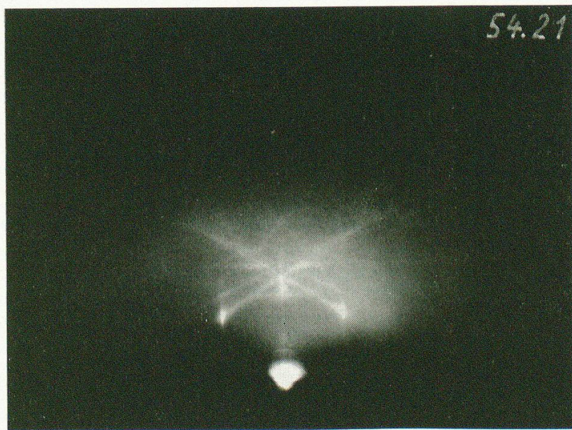
Fig. 1. Unbearbeitete Quarzoberfläche, Quarzinterferenzen und Kikuchilinen.
