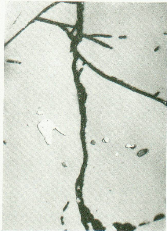
Fig. 7. Einschlüsse von ged. Gold und Kupferkies in Pyrit. 170 \times , Gondo.
