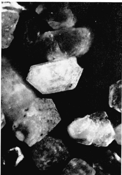
Fig. 8. Zonarbau der Zirkone (Typus a); die mikrokristallinen Bereiche sind zum Teil an einzelne Zonen gebunden. Rotondogranit, Ultropak, Vergr. 280\times .
