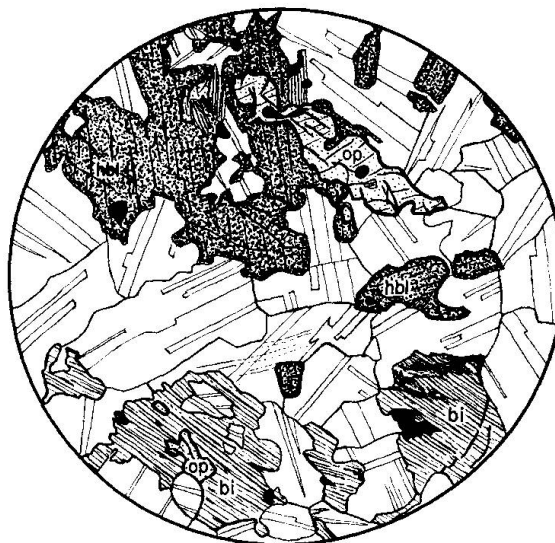
Fig. 2. Roccia senza K-feldspato (IV 101). Orneblenda (hbl) e biotite (bi) che derivano da pirosseno rombico (op), presente in lembi residui.
