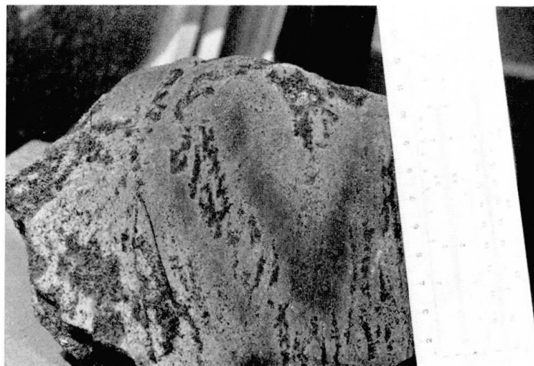
Fig. c) Echantillon S 8 . Pli isoclinal d'une amplitude d'environ 8 cm. Noter les formes caractéristiques des plis mineurs sur les flancs et dans la charnière.
