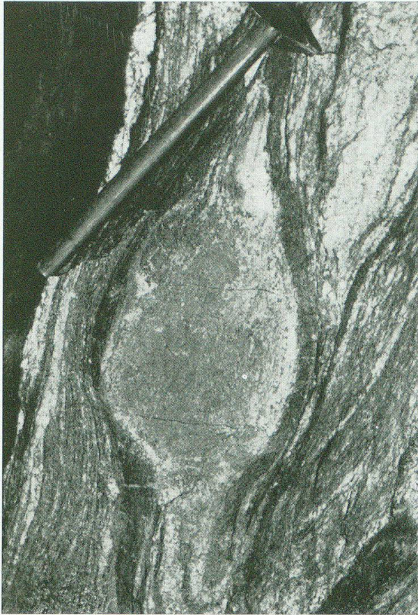
Photo 1. Kalksilikatfelslinse in Biotit-Plagioklas-Gneisen (Hammerstiel = 35 cm). Zuleitungsstollen, unterer Teil, m 708.
