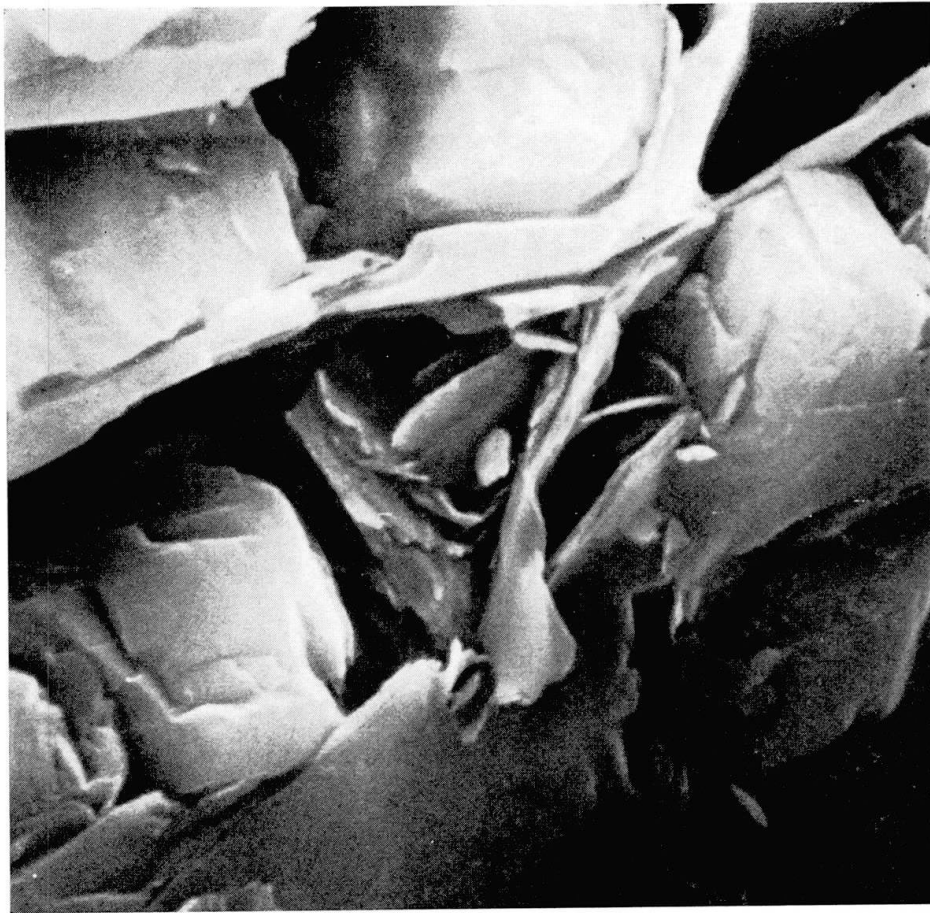
Fig. 7. Ausschnitt des Opalinuston-Aggregates. Raster-Elektronenmikroskop, 10000fach.
